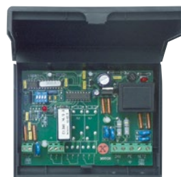
Boîtier décodeur Pour claviers à code CTR 1b-1, CTR 3b-1, CTV 3-1 et CTP 3
